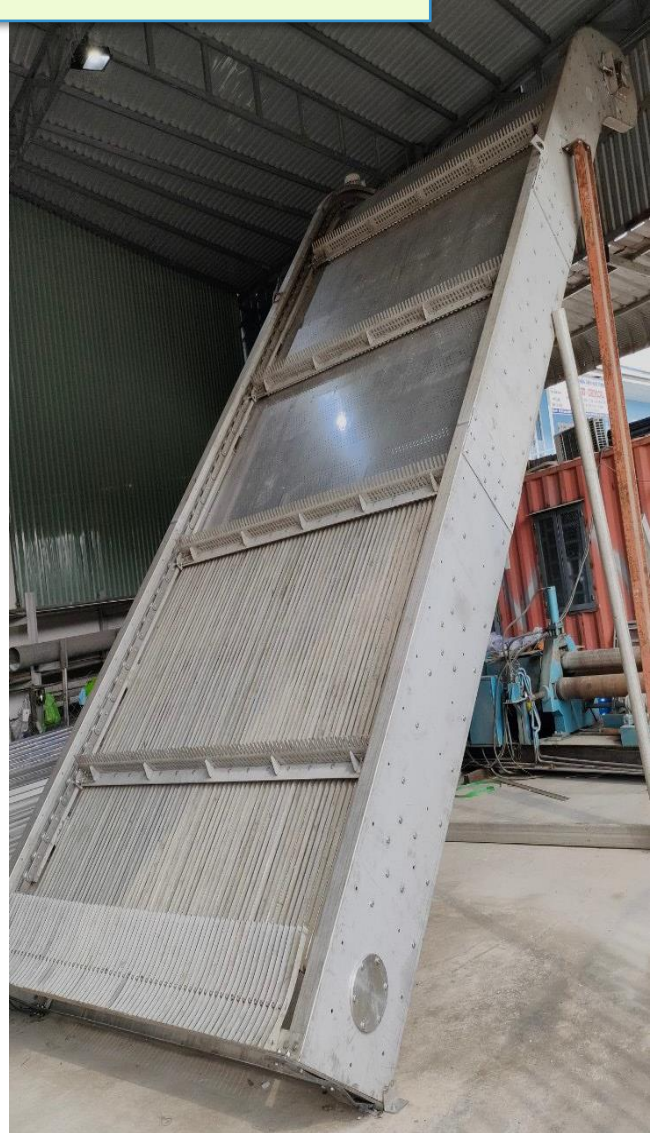
Hình ảnh 1: Máy cào rác dòng sông/ trạm bơm nước thô
