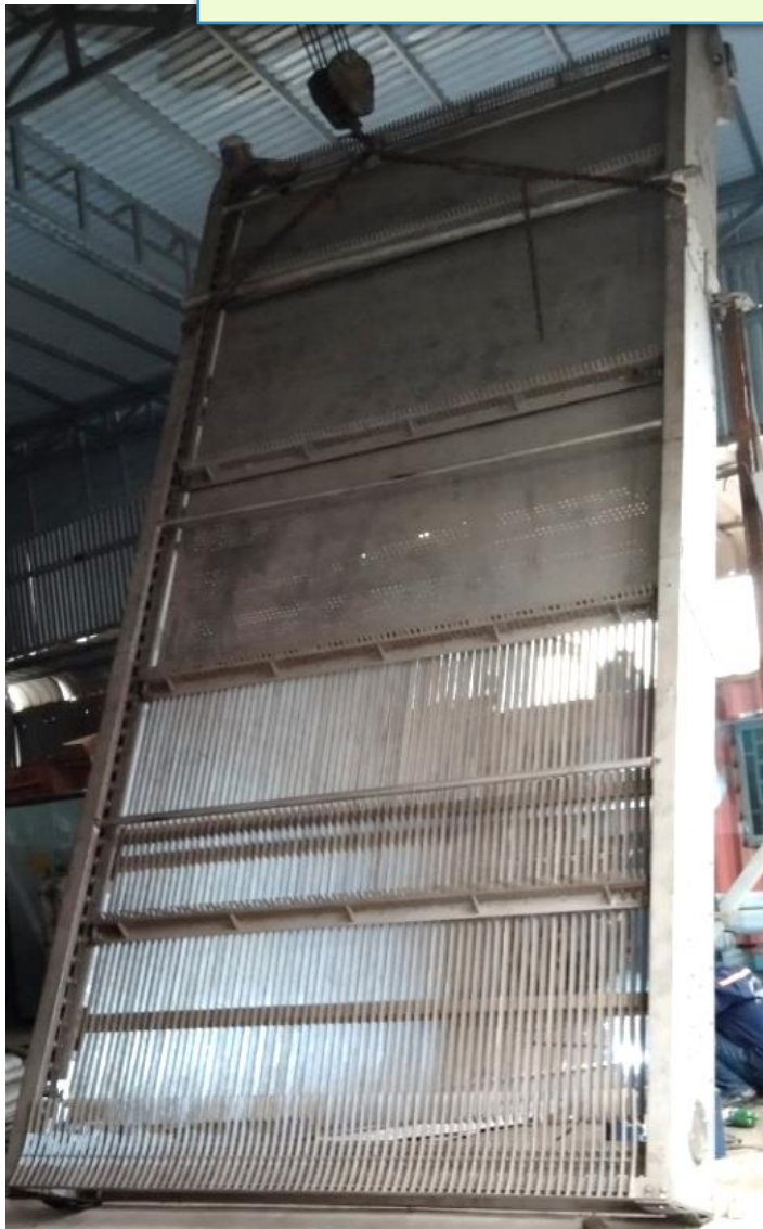
Hình ảnh 1: Máy cào rác dòng sông/ trạm bơm nước thô
